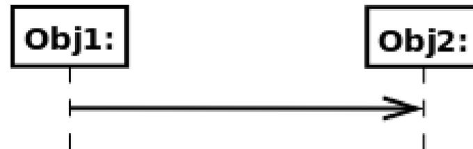
Figure 29 : Représentation d'un message asynchrone
